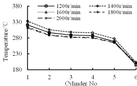
(d) Maximum Surface Temperature of the Cylinder Liner
