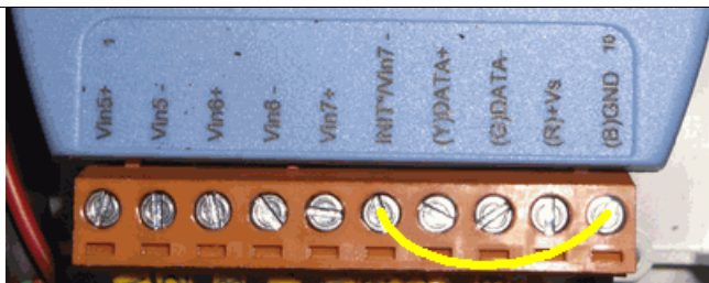
Рисунок 3.9. Перемычка на модуле I-7018 (обозначена желтым цветом).
